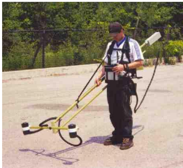
Magnetômetro de bombeamento óptico, foto retirada do Google imagens.
